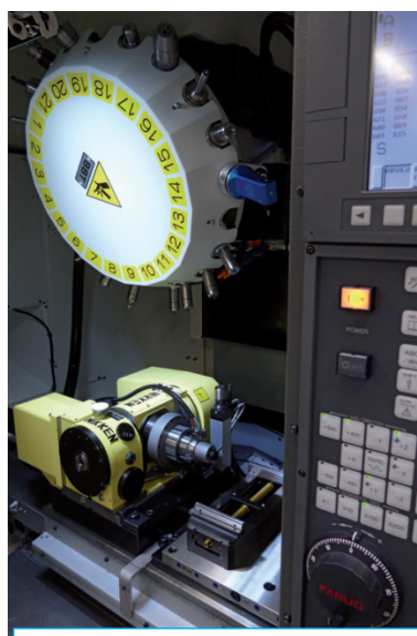
Centre Fanuc Robodrill \alpha -D21LiA5 équipé d'un plateau diviseur Nikken pour la fabrication de pièces de sous-traitance pour l'horlogerie.
